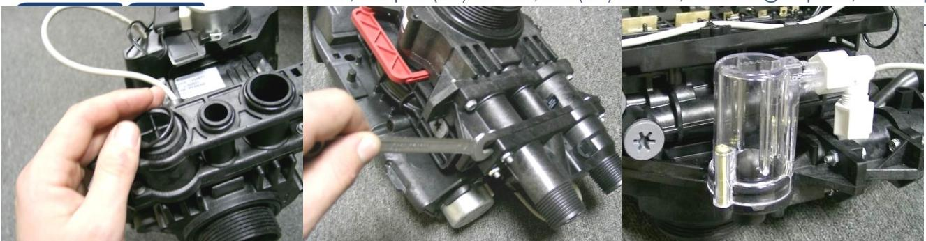
3. На блок управления модели 255, предварительно нужно установить Aircheck, присоединительный монтажный комплект и уголок для солевой трубы.
