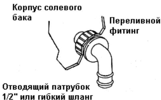
**Внимание:** категорически запрещается соединять дренажную линию клапана управления фильтра и переточную линию бака-солерастворителя!
