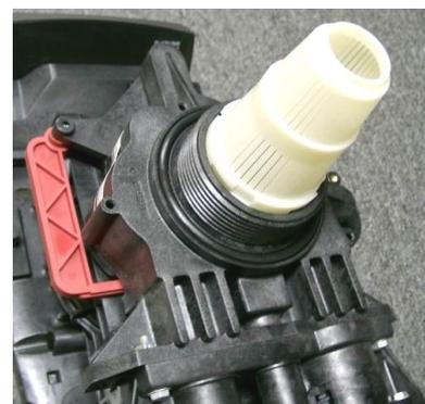
часовой стрелке (при виде сверху) до конца. Не прилагайте больших усилий - клапан должен поворачиваться легко. Сопротивление усилию должно появиться только в конце при сжатии резинового уплотнения.
