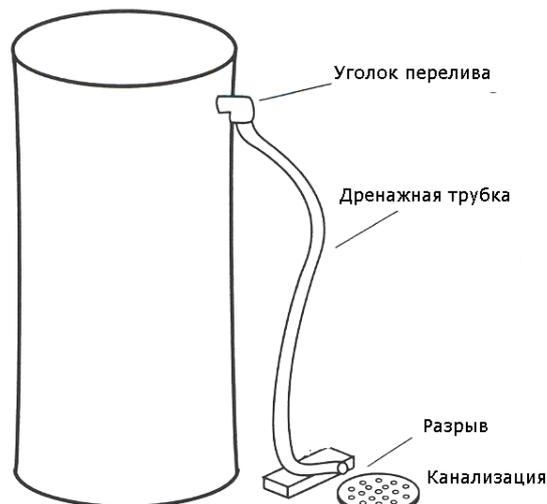
Присоединять трубку перелива к дренажной линии запрещено – при промывке фильтра вода может попасть в реакгентный бак. Трубка должна иметь собственный выход в канализацию с разрывом струи в обязательном порядке.
