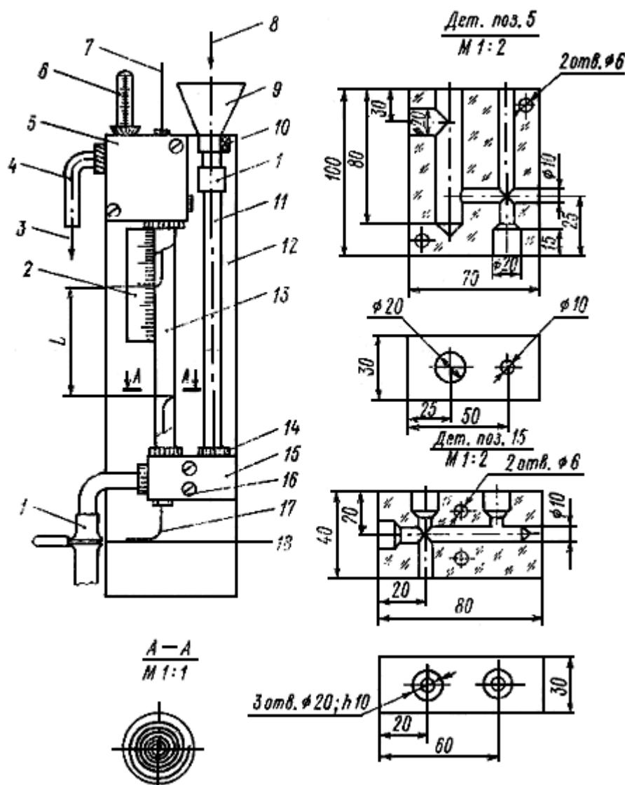
1 - резиновые трубы; 2 - шкала подвижного электрода; 3 - выход пробы; 4 - колено; 5, 15 - верхняя и нижняя головки из оргстекла; 6 - ртутный термометр; 7, 17 - подвижный и неподвижный электроды из никромовой проволоки  $d = 0,5 \div 1,0$  мм; 8 - вход пробы; 9 - воронка; 10 - скоба; 11 - подводящая стеклянная трубка; 12 - панель 100x350 мм; 13 - стеклянная трубка датчика; 14 - резиновая пробка; 16 - болт М5; 18 - зажим пружинный
