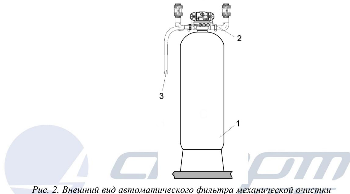
Рис. 2. Внешний вид автоматического фильтра механической очистки серии «HFM»
