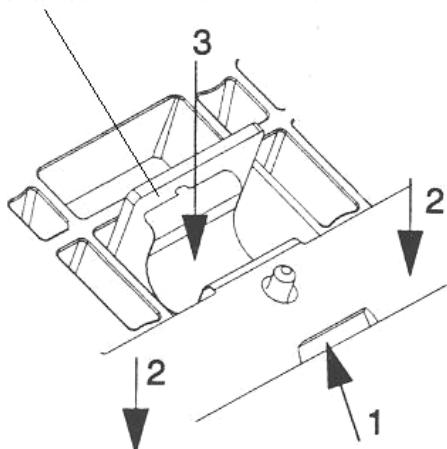
5. Задний конец пружины должен встать на свое место. Сегменты пружины должны находиться на пластинах пилотных клапанов. Для дальнейших операций потребуется отвертка.
