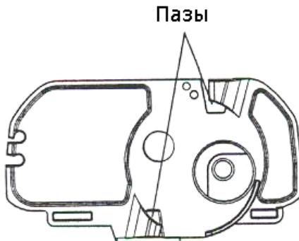
**Заметка:** перед установкой двигателя нет необходимости поворачивать вал в какое-либо определенное положение. После установки и включения питания, двигатель самостоятельно провернет вал до начального положения согласно сигналам с оптического датчика.
