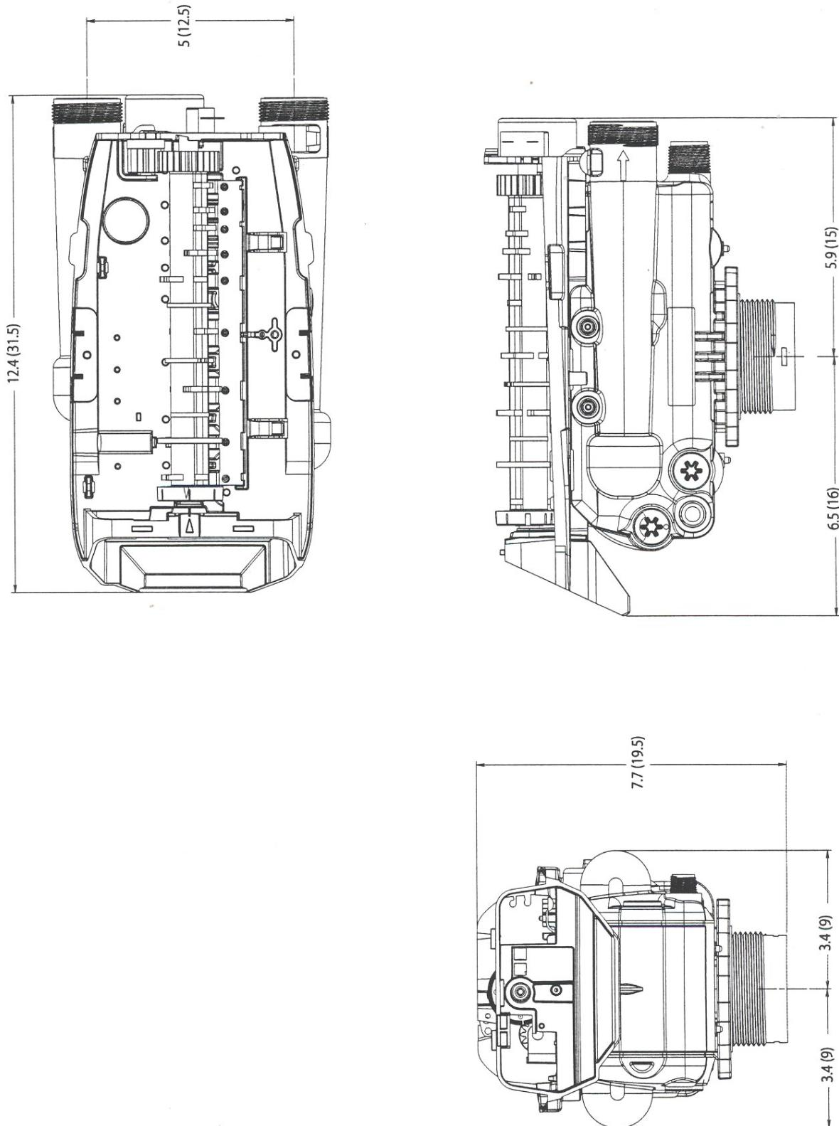
**Клапан серии Performa без крышки**
