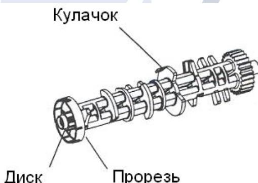
Вал-программатор имеет несколько кулачков, которые, при вращении, нажимают на пластины пилотных клапанов. Вращение производится двигателем посредством зубчатой передачи. На переднем конце вала есть чашеобразный диск с прорезями для контакта с оптическим датчиком.
